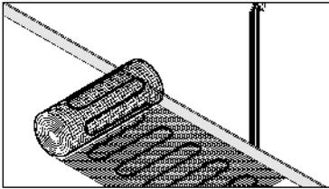
In der Nähe der Anschlussdose mit dem Verlegen der Heizmatte beginnen. Die Heizmatte mit dem Heizleiter nach oben ausrollen und dem Grundriss anpassen. Die Heizmatte ist selbstklebend!
