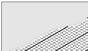
und sicherstellen, dass der Heizleiter vollständig mit Fliesenkleber oder mit Fließmörtel umschlossen wird.
