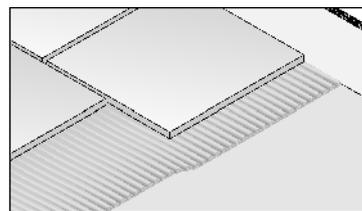
mit dem Verlegen des Deckbelags beginnen. Keramische Beläge mit flexiblem Fliesenkleber und Zahnpachtel verlegen. Bei anderen Oberbodenbelägen wie z. B. Laminat, Teppich, PVC den Heizleiter mindestens 5 mm mit Fliesenkleber bzw. Fließmörtel überdecken.
